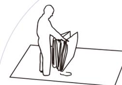
**1** 設置予定箇所をきれいに清掃し、ポリシートを床に敷きます。慎重に箱を開けます。(カッターを使用する場合は製品にキズが付く可能性があります。)慎重にD-Conシステムを取り出します。※D-Conシステムは、底部に水シャワー用の段差と青いエントリーポートのある洗身室、それらが付いていない更衣室・前室の合計3つの独立した部屋で構成されています。
