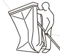
**2** 先ず、1ユニットを広げ、入口部分からトップパネル(天井部分)を持ち上げて、部屋ユニットを垂直に立てます。部屋ユニットに入り、ボールを角から5~6センチの位置にある指定された場所に差し込んで突っ張り、固定します。対角線上の順番にボールセットを差し込むと組み立てが容易です。尚、ボールは別売りのためユニットに含まれていません。別途、お買い求めください。
